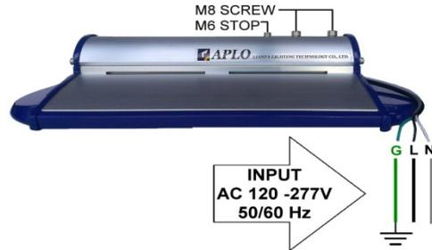
2. 完成接線後，將燈桿插入燈體內，請確實燈桿塞入至擋件(stop 螺絲)處。燈具發光面請調整至適宜角度，使用 M8 內六角螺絲將燈體鎖緊至燈桿。請確實檢查 M8 螺絲是否都牢牢將燈具固定。
